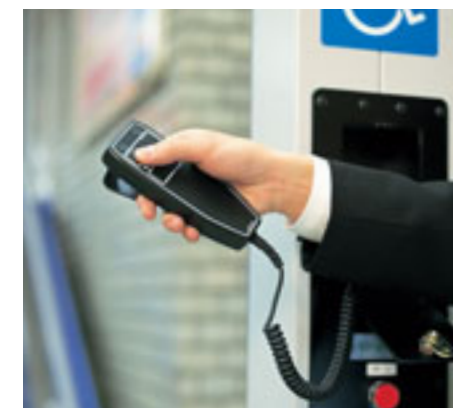
ペンダントスイッチ 管理者がスムーズに操作できるコード付きのスイッチ。
