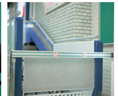
遮断棒 遮断棒は運転時の歩行者の侵入を防ぐ。(挟まれ防止装置付き。)
